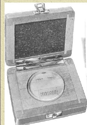
One se naslanjaju na ispitivanu površinu i osvetle dnevnom ili monohromatskom svetlošću. Ukoliko naslanjanje na površinu zbog neuravnjenosti nije potpuno, stvorice se vazdušni klin, koji omogućuje pojavu interferentnih pruga. Prema obliku I broju ovih pruga, može se doneti sud o uravnjenosti kontrolisane površine. Dozvoljeno odstupanje uravnjenosti planparalelnih stakala iznosi  $0.1\mu\text{m}$ . Firma Zeiss ih izrađuje u 4 veličine.
